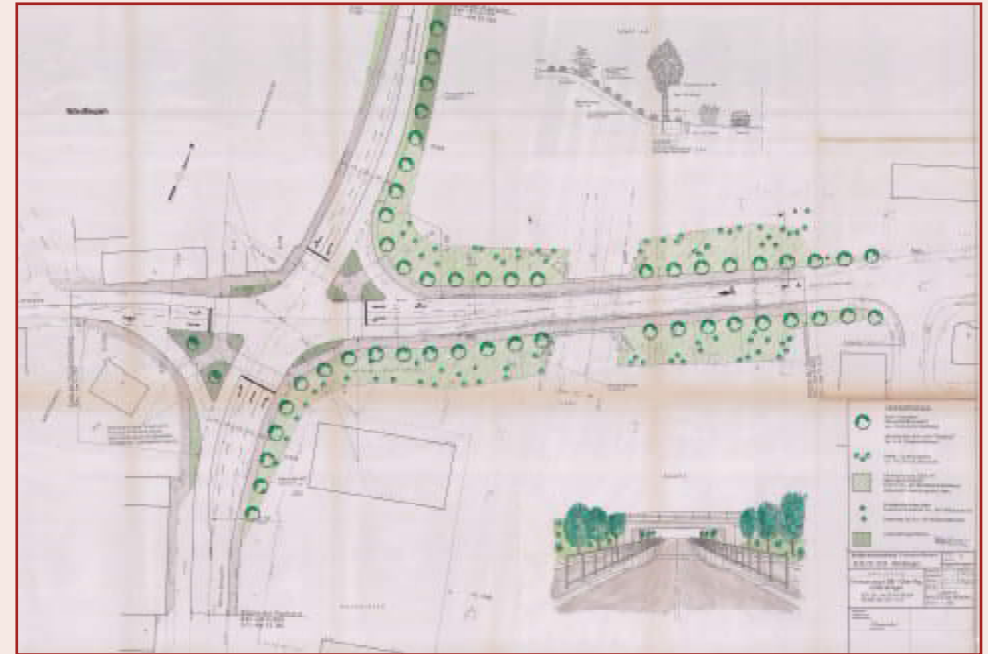
Variante mit nur 3 Gleisen aus den 1990ern: Einkürzung auf 22 Meter und bereits mit beidseitig höherliegenden Gehwegen
