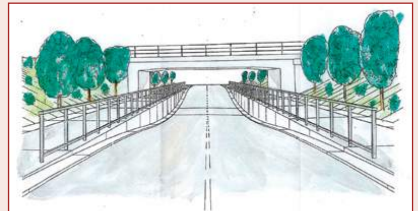
Variante mit nur 3 Gleisen aus den 1990ern: Einkürzung auf 22 Meter und bereits mit beidseitig höherliegenden Gehwegen
